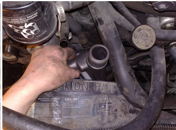
En god pakningsement husk også silicone på boltene som er i kontakt med vann, jeg lot siliconet mot pumpen og pakningen herde i 10 min slik at de var fast
