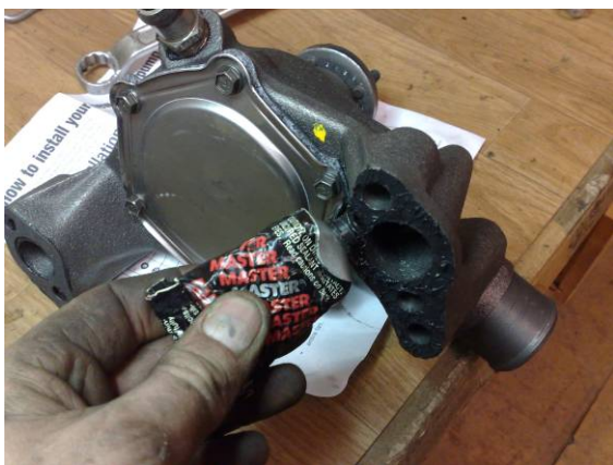
En god pakningsement husk også silicone på boltene som er i kontakt med vann, jeg lot siliconet mot pumpen og pakningen herde i 10 min slik at de var fast
