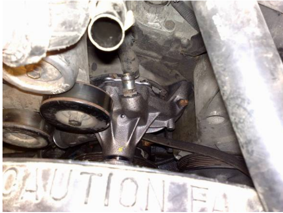
Litt krangel med boltene og en pakning som løsnet, lirk så viften på plass
