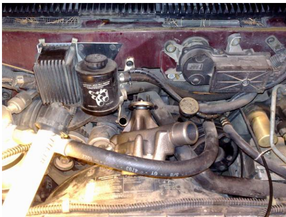
En god pakningsement husk også silicone på boltene som er i kontakt med vann, jeg lot siliconet mot pumpen og pakningen herde i 10 min slik at de var fast
